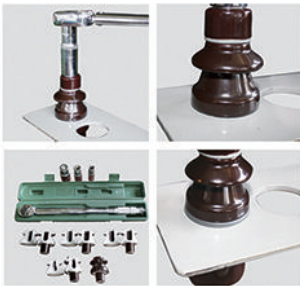
瓷瓶破坏性试验体现了瓷瓶的同质性和胶垫的弹性与瓷瓶预留的最佳压缩量。
